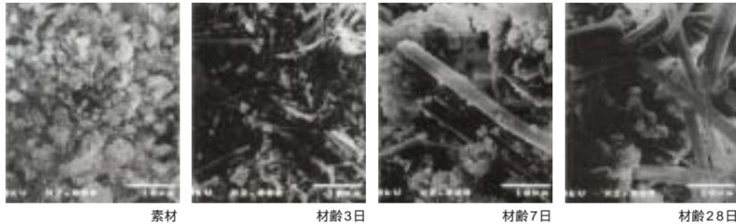
写真3 SIRCによる結晶作用の様子
